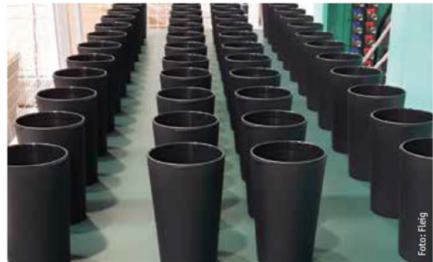
Stabiler Prozess: Die Eigenheiten bei der Verarbeitung von biobasierten und kompostierbaren Materialien für diese Mehrwegbecher sind beherrschbar.
