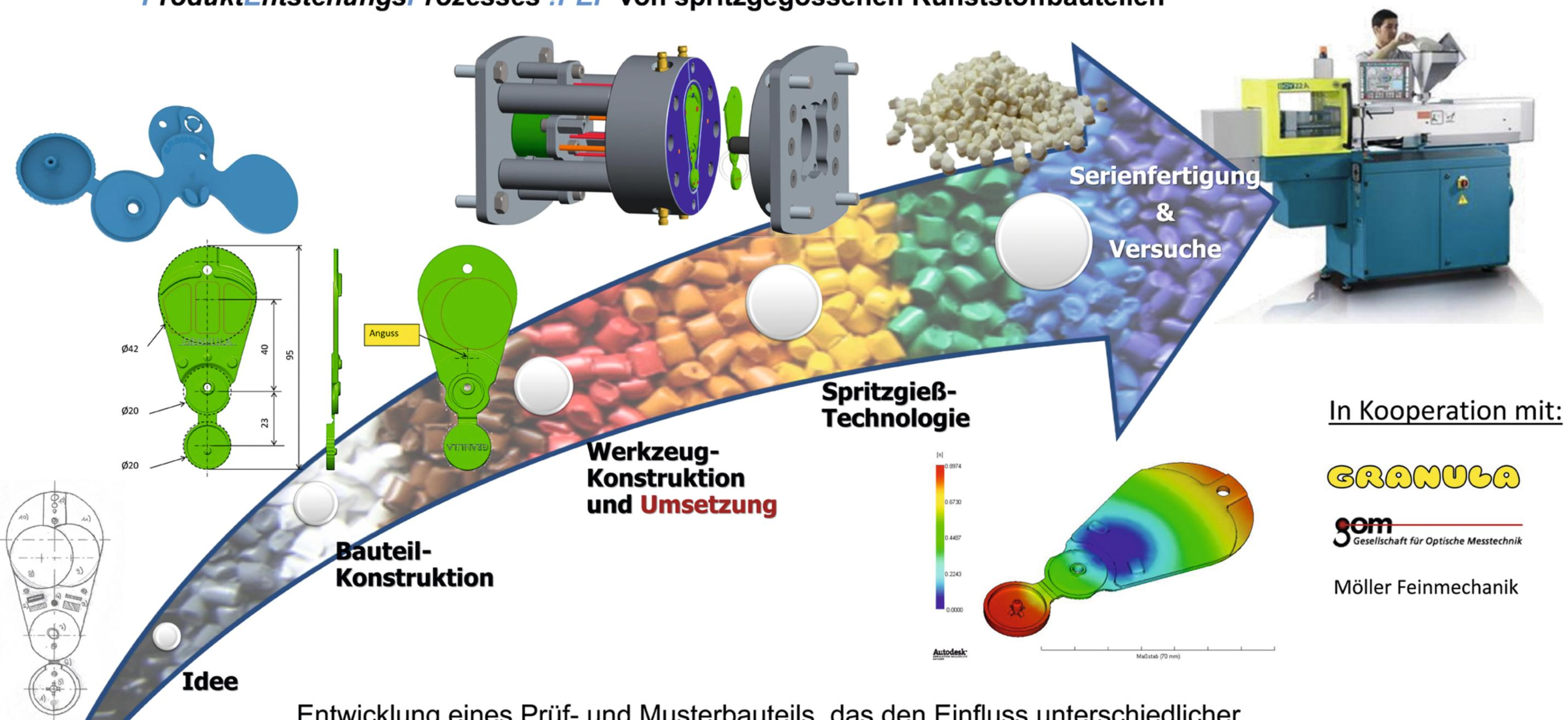
Entwicklung eines Prüf- und Musterbauteils, das den Einfluss unterschiedlicher Masterbatches auf die Bauteileigenschaften (Farbe, Festigkeit, Transluzenz etc.) aufzeigt und vergleichbar macht.
